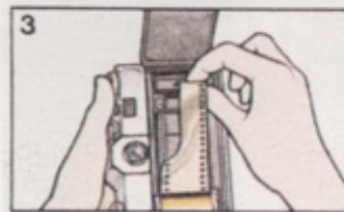
Fissate la coda della pellicola nell'apposita fessura sul rullino vuoto, assicurandovi che i fori della pellicola s'inseriscano sulla dentatura.
