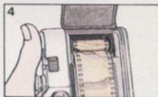
Avvolgete la pellicola alternativamente premendo il bottoncino dello scatto e muovendo la leva del riavvolgimento.
